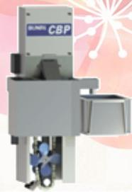
クーラント液の腐敗や臭気の発生にお困りではないでしょうか？従来のCBSと比べて回収量が約1.6倍UPしました。独自のプロペラとバケットにより浮上油・スカムを効率よく回収します。水溶性クーラントに混入した作動油・潤滑油・スカムを除去して液の腐敗や臭気の発生を防止します。低粘度の浮上油や洗浄機の加温している液にも効果的です。ベルト方式と比べた場合でも消耗品が少なく耐久性に優れております。
