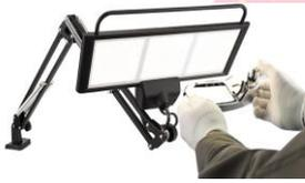
外観検査では、「目が疲れる、肩が凝る」「光が眩しくて見えづらい」「生産性を向上したい」という困りごとをよく聞きます。そんな困りごとにごこの外観検査用有機EL照明はいかがでしょう。有機EL照明は眩しすぎず目で見ても優しいという新しい光源です。LED照明よりも照り返しが少なく、ブルーライトの波長が抑えられているため生体リズムへの影響を与えにくく、目が疲れにくい光です。有機EL照明の特徴である平面から拡散する光は均一に広がり、全体をやさしく照らすので見逃しの低減や生産性向上にも繋がります。また、アームによって簡単に位置調整ができ、様々な角度から製品を検査することが可能です。
