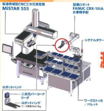
パレットのバーコードを読み取り測定プログラムによって自動測定を行ないます。昼休み・夜間にも測定機を稼働でき多品種製品にも
